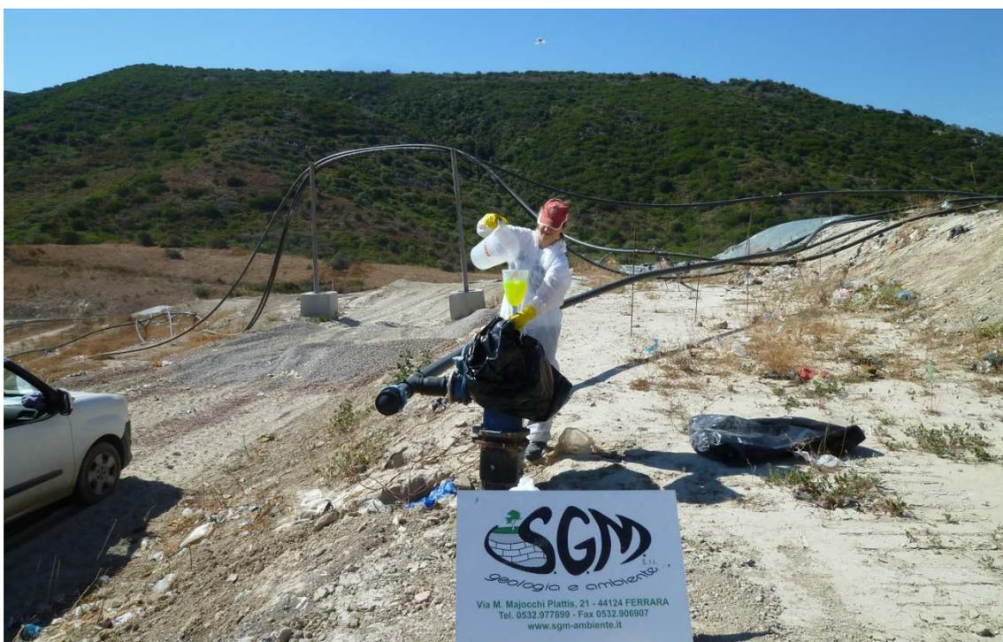
Figura 2. Immissione di un'aliquota di Fluoresceina sodica presso un pozzo biogas della discarica consortile.
