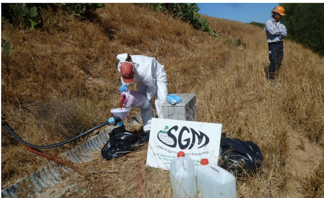
Figura 3. Immissione di un'aliquota di Amidorodamina-G presso un pozzo biogas della discarica comunale.
